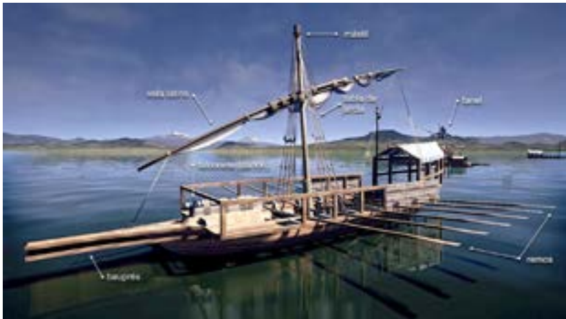
Figura 12. Aspecto de una fusta utilizada durante el asedio a Tenochtitlan en 1521, según Jesús Medina (2021). Dimensiones: manga (largo), 13 m sin contar el bauprés; eslora (ancho), 3 m; calado, 60 cm; alzado, 1 m. Artillada con un falconete en la proa, tripulación de 25 efectivos, velocidad 5 nudos (10 km/h)
