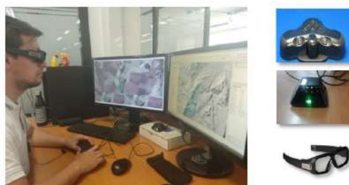
Figura 3. Estación de trabajo para interpretación con estereoscopia digital. Fuente: Vargas et al. (2020)
