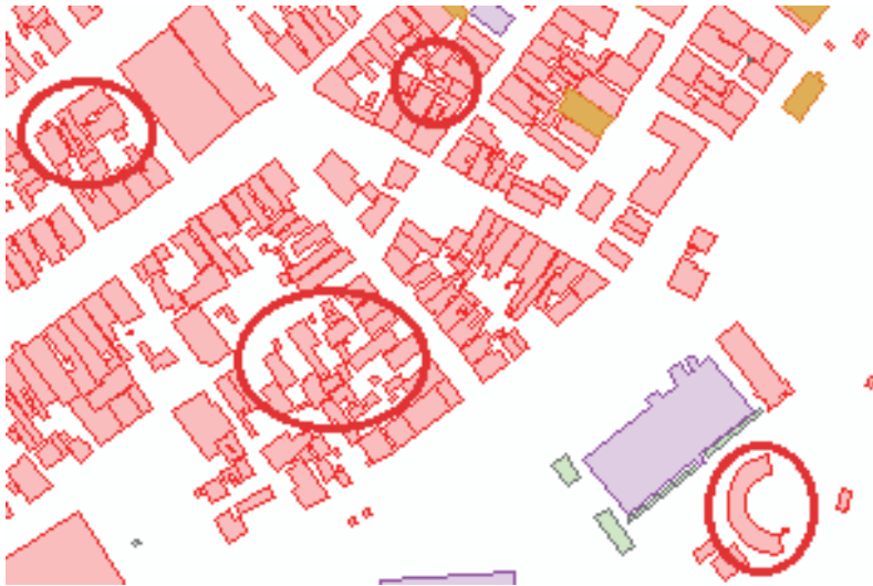
Figura 4. Recorte da carta do Centro Histórico de Paranaguá na escala 1:5.000 com a identificação de áreas com problemas de representação.
