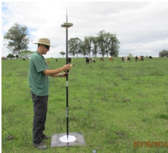
Figura 2. Levantamento de pontos de apoio ao levantamento aerofotogramétrico.
