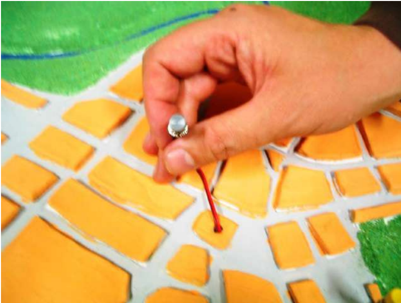
Figura 11. Sensor de tacto para inserción de sonidos en una maqueta táctil. Fuente: Sena, 2008, p. 130.
