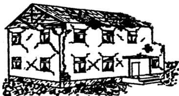
**Grado 4: Daños muy severos , (daño estructural severo, daño no estructural muy severo)**
