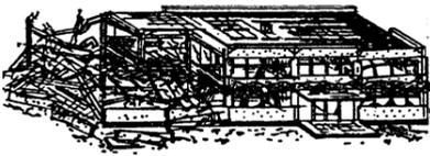
**Grado 5: Destrucción (daño estructural muy severo)**
