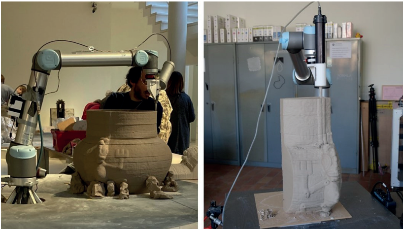
Figura 1. Experimentação com a impressão em argila da urna do Museu Nacional durante o Design Fest Gent. Foto: Estúdio Unfold.
