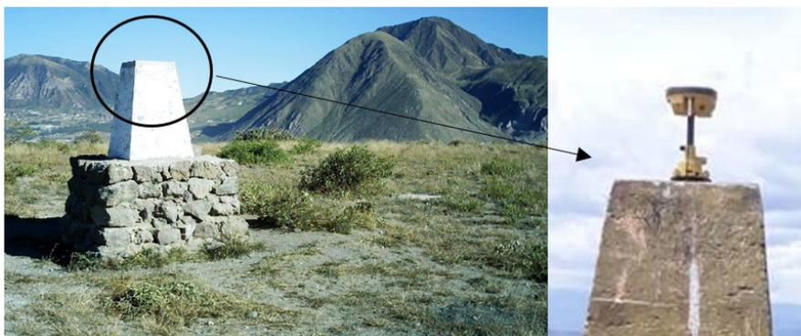
Figura 3. Antena base para el levantamiento geodésico.
