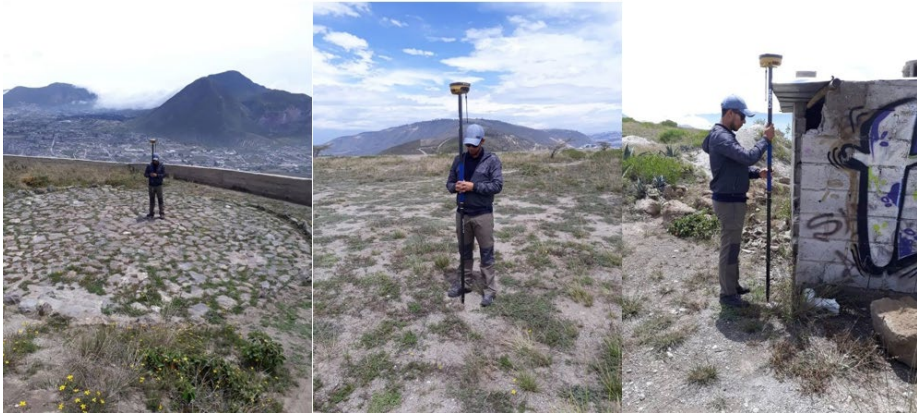
Figura 5. Toma de puntos de chequeo y GCP mediante RTK.
