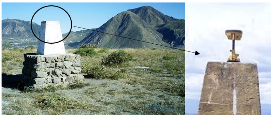
Figura 3. Antena base para el levantamiento geodésico.
