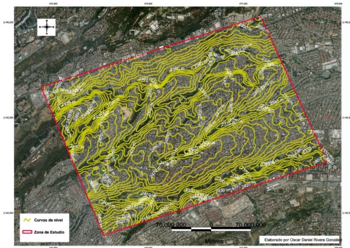
Mapa 15. Elaboración propia con base en datos obtenidos de Modelos de Elevación (MDE) archivos tipo Raster. Elaborado con Software GvSIG, Sistema de información Geográfica gratuito.
