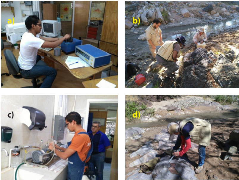
Figura 2. a) Mediciones en Magnetómetro de giro JR5 en el Laboratorio de Paleomagnetismo, b) Obteniendo muestras con la perforadora de rocas en campo, Huajapan de León, c) Corte de muestras en el laboratorio, d) Orientación de las muestras en campo, Huajapan de León.
