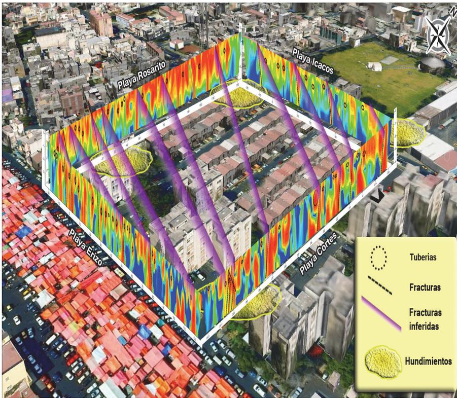
**Figura 7.** Localización de los perfiles en la zona de casas, correspondiente al barrio de Santiago. En general, la dirección de las principales fracturas inferidas muestra una dirección preferencial NW-SE. Los hundimientos o zonas de subsidencia coinciden en áreas en donde se ubican edificios que pueden estar asociados al gran peso que representa cada uno de ellos, y que provoca colisiones en sus estructuras y un creciente riesgo a sus residentes.
